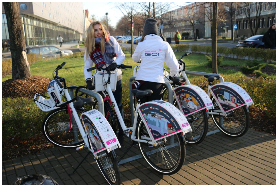
Fot. 9. Rowery SRP 4 generacji SimpliBike autorstwa wrocławskiej firmy SimpliGo. Elektroniczny panel wypożyczeń, moduł komunikacji oraz wbudowany elektrozamek wraz z zapięciem znajdują się na przednim bagażniku. Tylony błotnik zawiera instrukcję wypożyczenia oraz mały panel fotowoltaiczny. (fot. materiały operatora)
