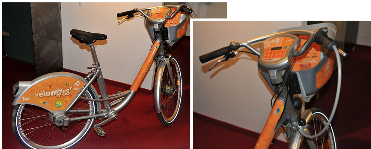
Fot. 6. Rower systemu 3/4 generacji firmy Smooove - wyposażony w monitoring GPS, wbudowany panel wypożyczeń oraz zapięcie umieszczone w rurze kierownicy. (fot. źródło własne)
